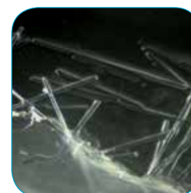
Närvaro av fibrer i everX Posterior ökar adhesionen genom mekanisk bindning. University of Turku, Finland, 2013. Förstoring: x16
